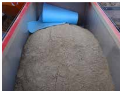
Aggregaatkamer beladen met dekvloerzand
