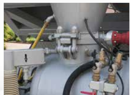
Gesloten mengketel tijdens het pompproces
